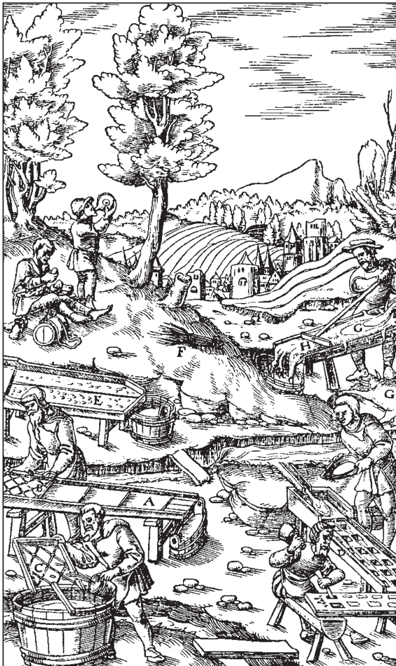
Der Holzschnitt von G. Agricola aus dem Jahre 1556 zeigt die Technik des Goldwaschens auf Planenherden. In den Rillen und Vertiefungen dieser Waschtische reichern sich die schweren Goldpartikel an, der leichte Sand, Kies und Steine werden fortgespült. Nach ähnlichem Prinzip beginnt hier die Goldgewinnung vor etwa 1000 Jahren. Möglicherweise werden zum Auswaschen des Goldes auch Tierfelle, grobe Tücher oder Rasen eingesetzt.
