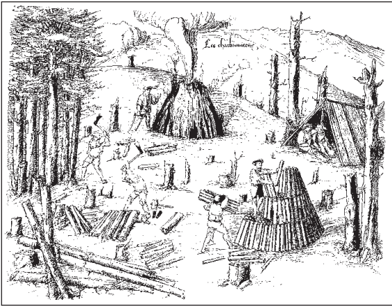
Aufbau und Betrieb von Kohlenmeilern. Die um 1550 angefertigte Federzeichnung lässt bereits die weitflächigen Abholzungen erkennen. Aus: H. Gross, La Rouge Myre de Saint Nicolas de la Croix (Vogesen)
